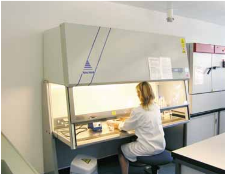
20 Hotte de sécurité de classe 2 pour travaux de microbiologie
